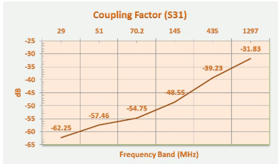
Le facteur de couplage sur 144 est de -48,5 dB (= un signal qui passe dans la ligne principale est disponible sur le port de la ligne couplée atténué de 48,5 dB). La directivité est de 25 dB (toujours sur 144) et la perte d'insertion de 0,01 dB.
