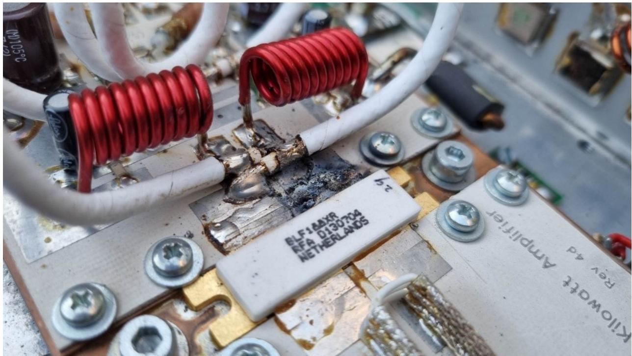
L'examen de l'ampli après sa défaillance montre une fonte partielle du drain droit et il y a un petit trou dans le drain, juste à la base du boîtier du transistor (voir photo). La vérification à l'ohm-mètre indique que le drain droit n'est plus en contact avec le PCB. A ce moment-là, je me dis qu'il faudra remplacer le transistor, ce qui ne me ravit pas. Un transistor neuf coûte 250€ et l'opération de dessoudage
