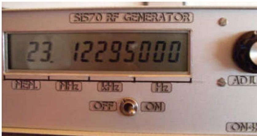
$12,295 + 16$  (Convertisseur) +  $116$  (Transverter) =  $144,295$  MHz, qui est la fréquence centrale de l'ensemble du SDR lorsque la fréquence du générateur affiche  $12,295$  MHz.
