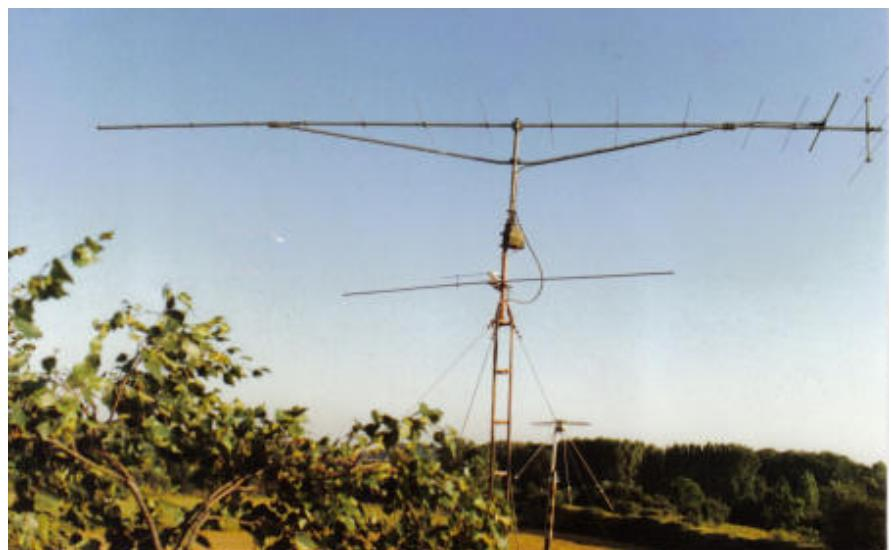
Début '90, ma 17 él. F9FT en J010WK. En-dessous du moteur d'antenne, se trouve le dipôle 6m orienté N/S.
