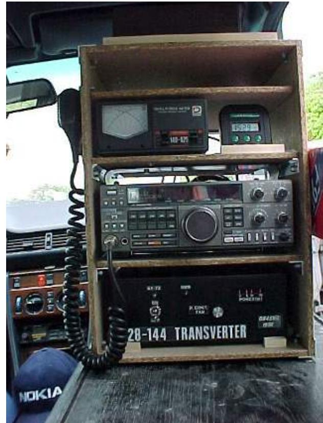
Mon équipement de contest portable utilisé jusqu'en 2002. Egalement utilisé tel quel dans le shack : très facile, il suffisait de débrancher l'antenne du shack et de mettre l'étagère dans la voiture pour une activité portable.
